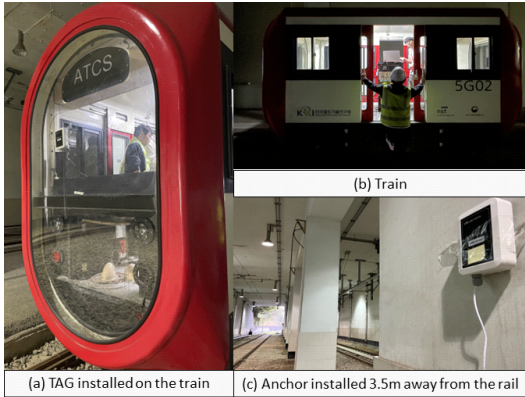
그림 3. UWB 기반 레인지 시스템의 구성 요소들. (a) 위치 정보를 효과적으로 전송하기 위해 열차 내부에 설치된 TAG. (b) 선로 위에서 정차한 열차의 모습. (c) 선로로부터 3.5m 떨어진 위치에 설치된 앵커로, TAG로부터 신호를 수신하는 역할을 수행 Fig. 3. Components of the UWB-based ranging system. (a) TAG installed inside the train to effectively transmit its location information. (b) Depiction of the train stationary on the tracks. (c) Anchor, installed 3.5m away from the track, which receives signals from the TAG.
